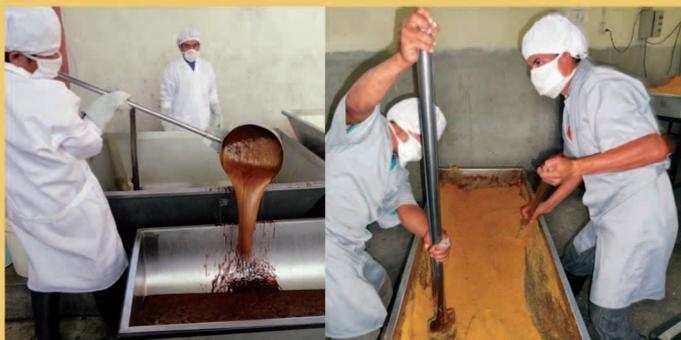
Il faut d'abord extraire le jus de la canne par pressage, il est ensuite filtré et décanté dans un premier bassin pour enlever les impuretés. Ensuite une cuisson d'environ 10 h dans différents bacs permet l'évaporation d'une grande partie de l'eau, pour obtenir un liquide épais de couleur marron : la mélasse. C'est un four qui produit l'énergie pour la cuisson, il fonctionne uniquement avec les restes des tiges de canne broyées et séchées, ce qui évite la déforestation.
